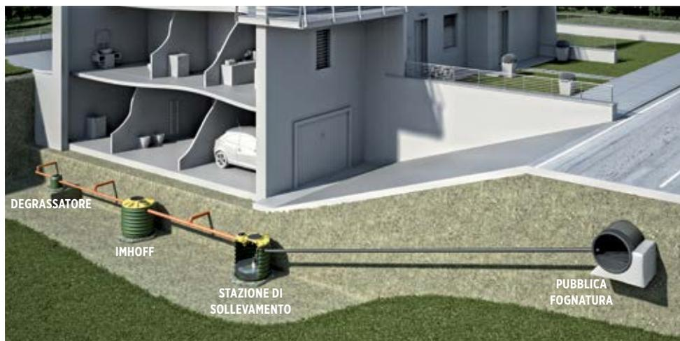
Le **stazioni di sollevamento** per acque nere sono sistemi che permettono di sollevare e trasferire reflui verso stazioni poste a **quote superiori** (sistemi fognari, sistemi di depurazione). Sono necessarie, ad esempio, quando la quota degli scarichi del WC è più bassa dell'impianto di depurazione o delle condotte fognarie (scantinati, locali interrati, ecc.) e anche quando il profilo idraulico del sistema di depurazione non riesce a svilupparsi per gravità.
