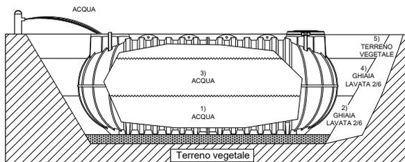
**2.2** Dopo aver riempito e rinfiancato in modo adeguato il serbatoio, ricoprirlo gradualmente con del **terreno vegetale (NON di natura argillosa/limosa, NON materiale di scavo)** per **30/40cm**, lasciando liberi i tappi di ispezione. In questo modo l'area interessata è **pedonabile** ed è **vietato** il transito di automezzi fino a 2m di distanza dallo scavo. **N.B. Per rendere il sito carrabile leggere il cap. 4 "Carrabilità".**
